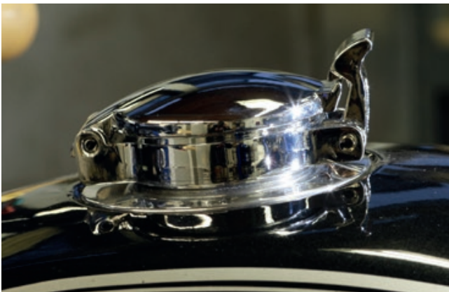
Aston-Tankdeckel mit Adapter montiert auf einer R 100 R
