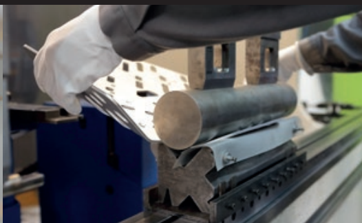
Abkanten, mit viel Erfahrung und Fingerspitzengefühl
