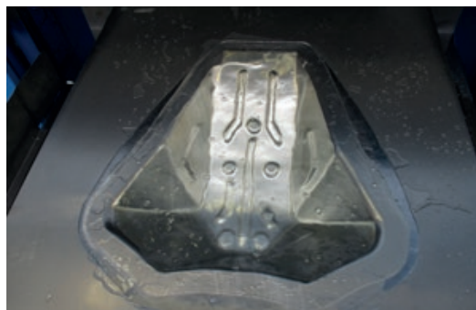
... geformte Motorschutz in der Matrize
