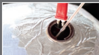
Der Reiniger (Granulat) wird mit Wasser angemischt und im Tank auf 60 Grad erwärmt.
