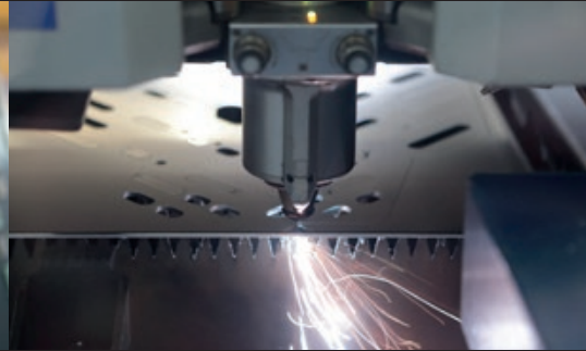
Laser schneidet computergesteuert die Aussparungen
