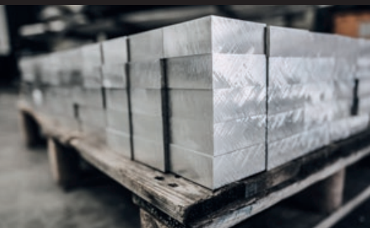
Aluminium-Barren zur Herstellung der Lenkererhöhung
