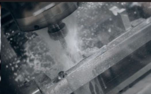
Fräsprozess, als Vorbereitung der Präzisionsbearbeitung
