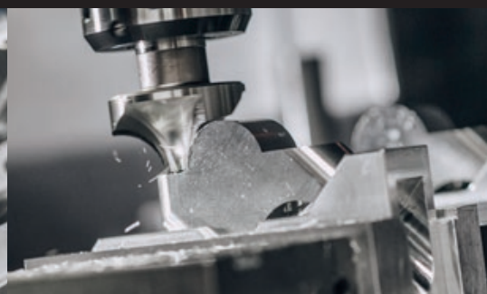
Fräsung des formschlüssigen Sitzes im Unterteil
