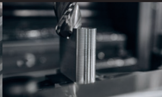
Präzise Formfräsung der oberen Formung
