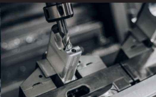
Bohroperation im Unterteil der Lenkererhöhung
