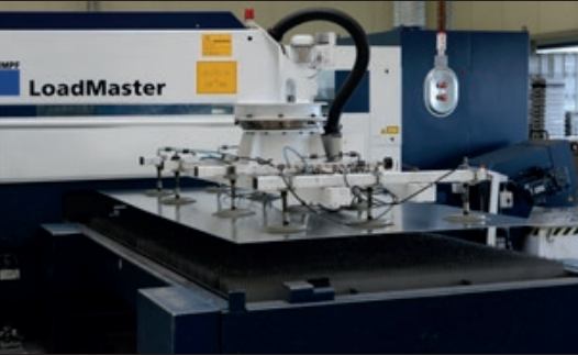
Aufnahme auf dem Tisch des Laserschneidzentrums
