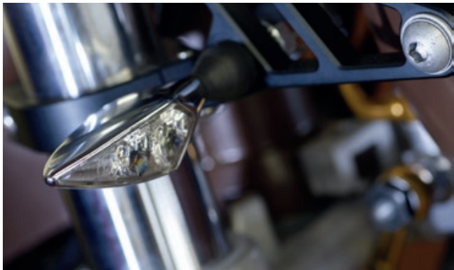
Der »Rhombus PL« für die Front mit zusätzlichem Tagfahrlicht
