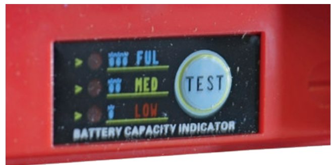
Beim Druck auf den »Testbutton« wird der Ladezustand der Batterie direkt angezeigt
