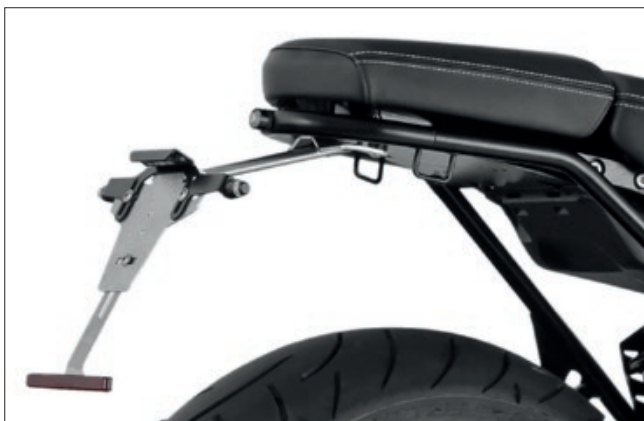
Heckumbau mit integriertem Rücklicht »DEVILS-EYE« mit Kennzeichenträger »RETRO SPORT« in Kombination mit Blinkersatz »M-PIN«
