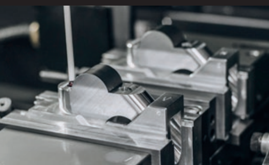
Computergestützte Maßkontrolle mit Rubinstein Spitze
