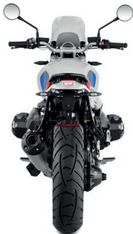
Kennzeichenträger »SWING« in Kombination mit Kellermann »MICRO RHOMBUS« Blinkern
