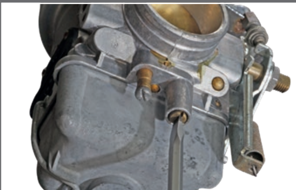
Leerlaufgemischschraube (7) ganz vorsichtig bis zum Anschlag hineinschrauben.
