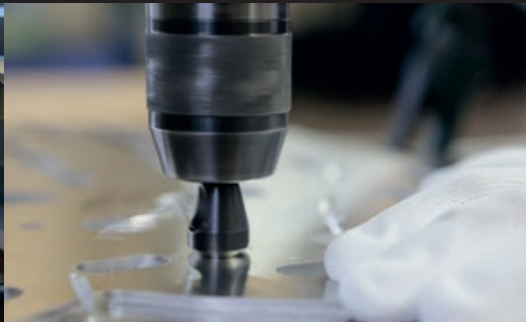
Die Bohrungen werden mit einem Kegelsenker »gesenkt«
